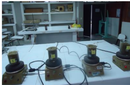
Figura 4. Muestras tratándose con peróxido ( H_2O_2 ).
